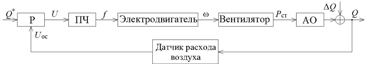
Рис.1. Функциональная схема системы управления
