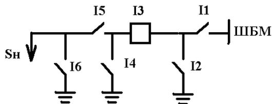
Схема расстановки аппаратов для логического контроля операций.
