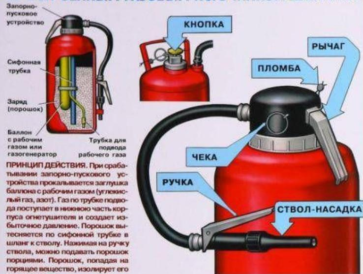
**ПРИНЦИП ДЕЙСТВИЯ.** При срабатывании запорно-пускового устройства прокаливается заглушка баллона с рабочим газом (углекислый газ, азот). Газ по трубке подвода поступает в нижнюю часть корпуса огнетушителя и создает избыточное давление. Порошок вытесняется по сифонной трубке в шланг к стволу. Нажимая на ручку ствола, можно подавать порошок порциями. Порошок, попадая на горячее вещество, изолирует его от кислорода
