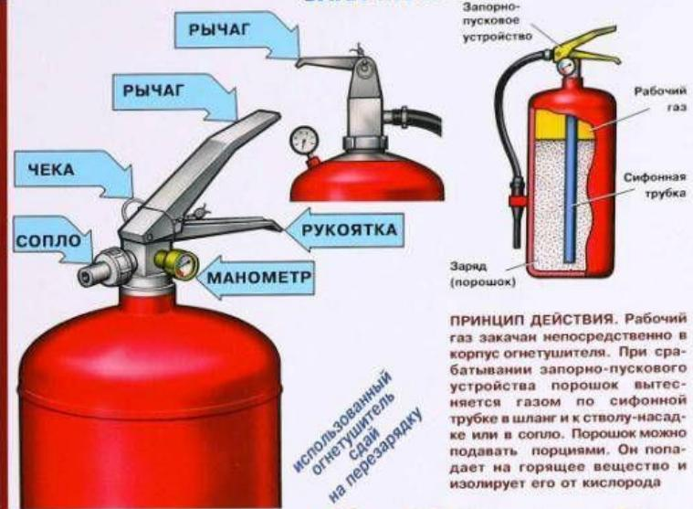
**ПРИНЦИП ДЕЙСТВИЯ.** Рабочий газ закачан непосредственно в корпус огнетушителя. При срабатывании запорно-пускового устройства порошок вытесняется газом по сифонной трубке в шланг и к стволу-насадке или в согло. Порошок можно подавать порциями. Он попадает на горячее вещество и изолирует его от кислорода
