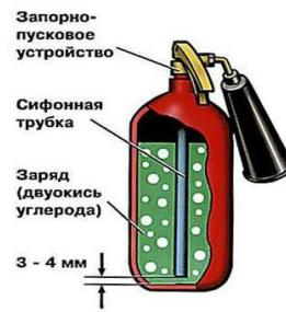
**ПРИНЦИП ДЕЙСТВИЯ** основан на вытеснении двуокиси углерода избыточным давлением. При открывании запорно-пускового устройства CO<sub>2</sub> по сифонной трубке поступает к растробу и из сжиженного состояния переходит в твердое (снежообразное). Температура резко (до -70 °C) понижается. Углекислота, попадая на горячее вещество, изолирует его от кислорода
