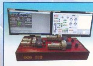
СЕТЕВОЙ ИМИТАТОР КОРАБЕЛЬНОГО ГАЗОТУРБИННОГО ДВИГАТЕЛЯ С ИНТЕГРИРОВАННОЙ СИСТЕМЫ ВИБРОДИАГНОСТИКИ
