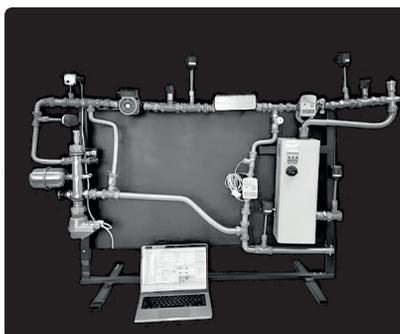
Лабораторный стенд активного теплового узла
