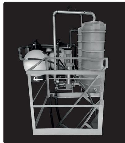
Установка очистки скважинной воды
