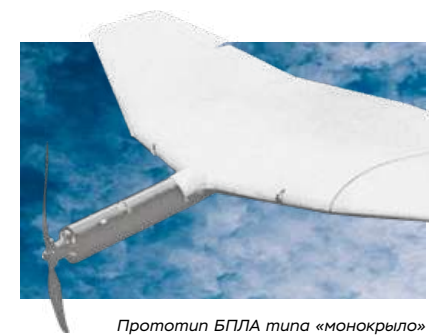
Прототип БПЛА типа «монокрыло» с вертикальным взлетом
