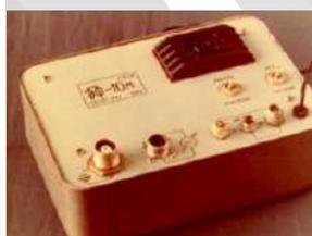
Эхолот — это измерительный прибор, использующий звуковые импульсы для исследования структуры и рельефа дна, обнаружения подводных объектов. Модель этого аппарата, разработанная в НЭТИ, экспонировалась на ВДНХ.
