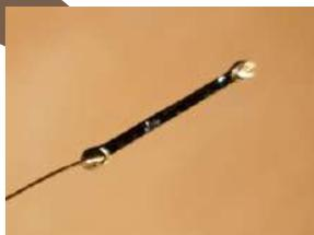
Полупроводниковые тензометры (приборы для измерения деформаций) с повышенным выходным сигналом. Чувствительность этих датчиков достигала 50 единиц, (у прежних — 2–3). Новые приборы были внедрены в производство и изготовлялись серийно. На основе работ кафедры в институте образовался первый в стране центр полупроводниковой тензометрии.
