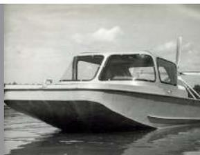
Снегоход-амфибия способен передвигаться по снегу любой глубины и плотности, льду, засоренным и заросшим водоемам, залитой водой весенней тундре и без подготовки переходил из одной среды в другую. В сравнении с существующими аналогами тех лет выгода эксплуатации разработки была шестикратной.
