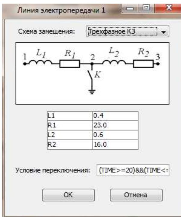
Рисунок 4.14 – Настройка параметров схемы замещения
