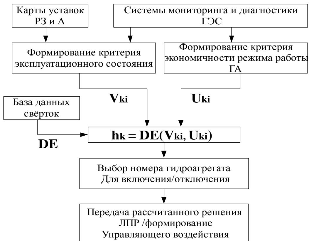
Рисунок 4.2 - Функциональная схема выбора состава гидроагрегатов
