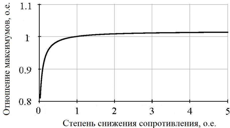
Рисунок 4.3 – Зависимость отношения максимумов мощностей от степени снижения сопротивления трансформатора
