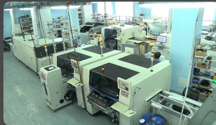
Автоматизированный монтаж печатных плат
