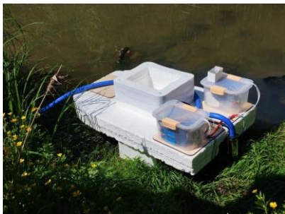
Рисунок 1 - беспилотный плавательный аппарат для отбора проб, использованный в работе
