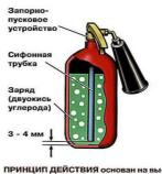
теснении двуокиси углерода избыточным давлением. При открываточным запорно-пускового устройства СО<sub>2</sub> по сифонной трубке поступает к раструбу и из сжиженного состояния переходит в твердое (снегообразпереходит в твердое (снегообраз-ное). Температура резко (до -70 °C) понижается. Углекислота, попадая на горящее вещество, изолирует его от
