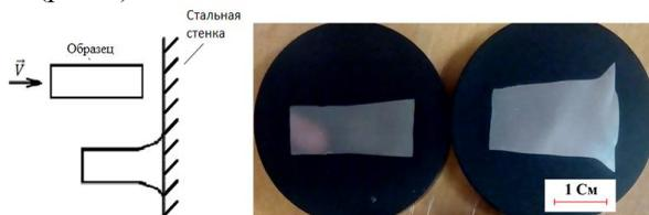
**Рисунок 1 – Схема испытания и разрез полученного образца в микрошлифе**
