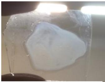
**Рисунок 4 Фотография плёнки с сильным светорассеиванием.**
