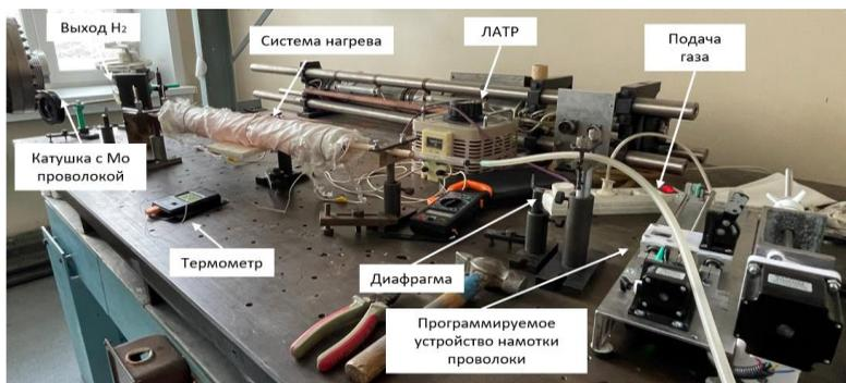
**Рисунок 2 – Система очистки конструктивных элементов**
