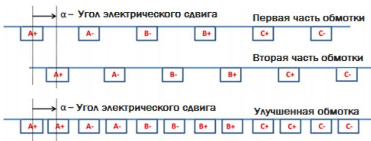
**Рисунок 1 – Общий принцип реализации сдвига части обмотки**
