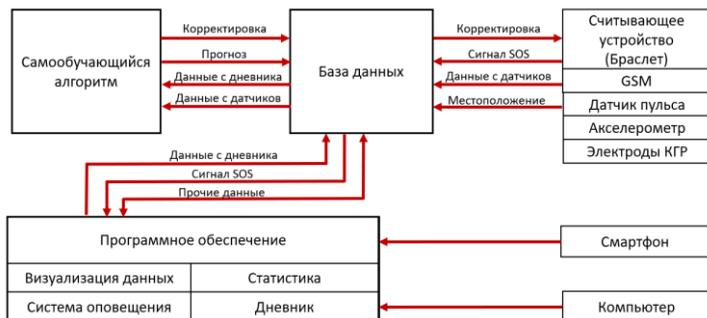
**Рисунок 2 – Функциональная схема системы**
