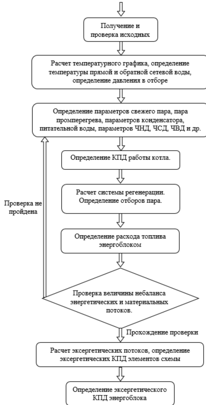
Рис. 2.4 Алгоритм расчета тепловой схемы энергоблока
