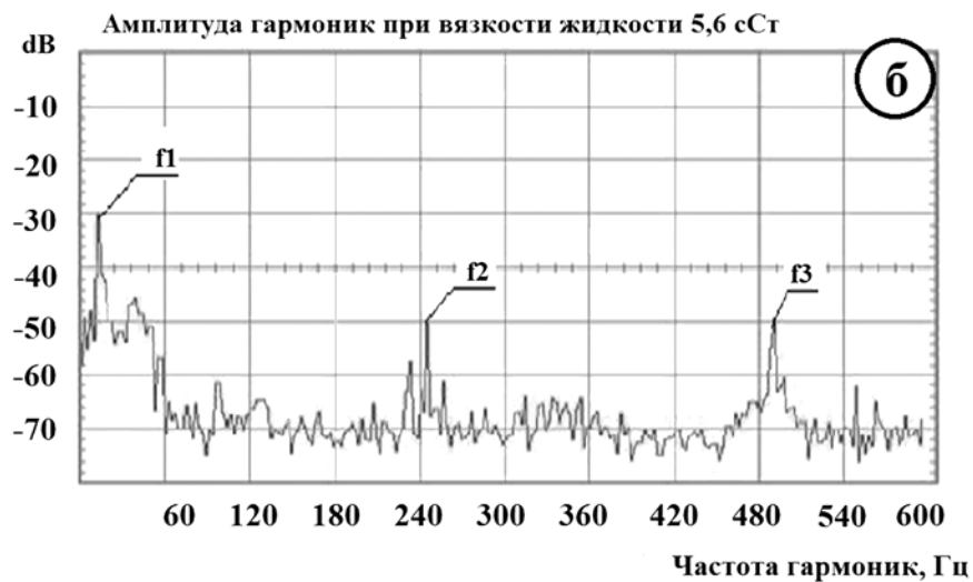
Рисунок 4.4 – Спектр пульсаций момента силы сопротивления (а) Re \sim 100 ( \nu = 54,4 \cdot 10^{-6} \text{ м}^2/\text{с} ); (б) Re \sim 1200 ( \nu = 5,6 \cdot 10^{-6} \text{ м}^2/\text{с} )
