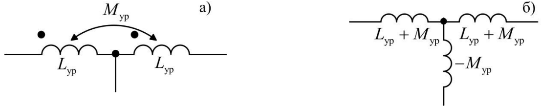
Рисунок 13 - Схема УР (а) и его эквивалентная схема с устранённой магнитной связью (б)
