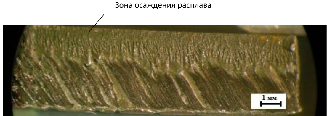
Рисунок 3.11 – Увеличение зоны осаждения расплава на поверхности реза нержавеющей стали 12X18H10T при уменьшении тока и скорости резки ( I = 26 \text{ A} , V = 0,9 \text{ м/мин} )
