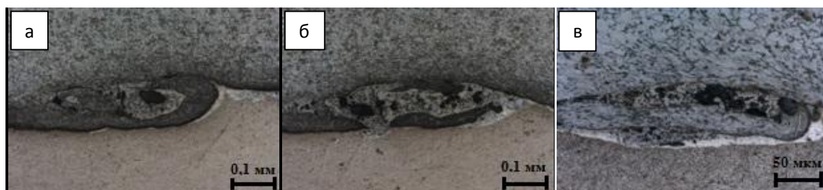
Рисунок 5.5 – Особенности строения «вихревого мешка» на стыке соединения «сталь Ст3 + алюминий А5М»
