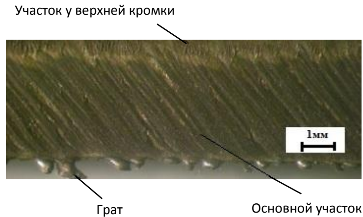
Рисунок 3.10 – Внешний вид поверхности реза нержавеющей стали 12X18Н10Т после тонкоструйной плазменной резки ( I = 30 \text{ А} , V = 1,3 \text{ м/мин} )
