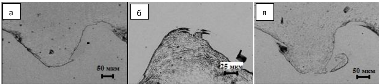
Рисунок 5.2 – Особенности волнового течения металлов на стыке соединения «сталь Ст3 + сталь 12X18H10T»
