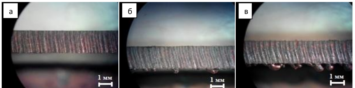
Рисунок 3.18 – Морфология поверхности реза меди М1 при разных скоростях обработки: а – V = 1,3 \text{ м/мин} ; б – V = 1,5 \text{ м/мин} ; в – V = 1,7 \text{ м/мин}
