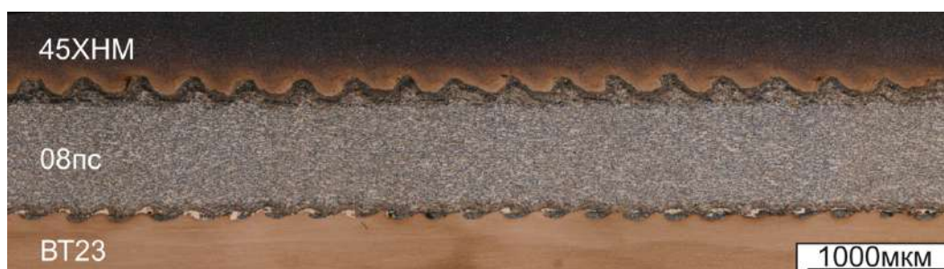
Рисунок 2.11 – Общий вид композиционного материала «BT23 – 08пс – 45ХНМ»
