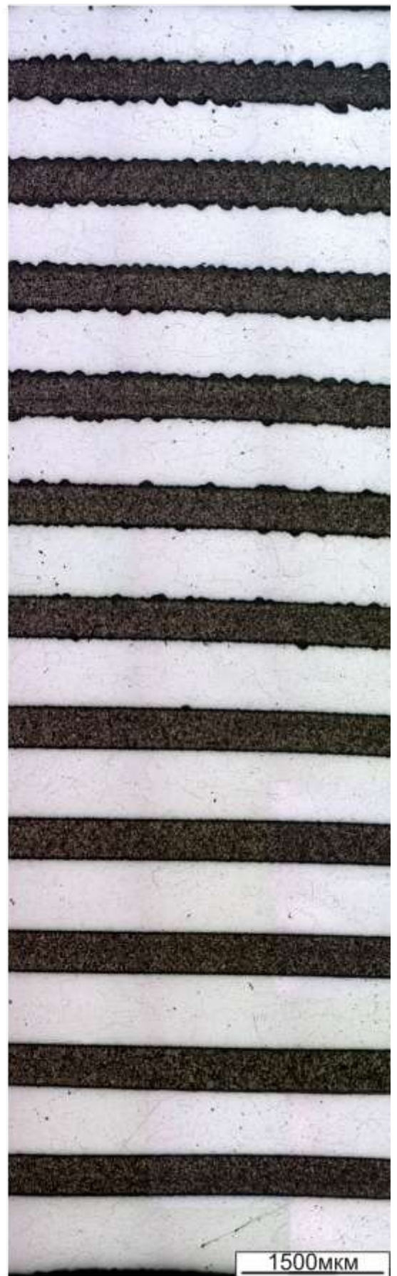
Рисунок 3.5 – Общий вид многослойного материала, сформированного путем сварки взрывом пластин алюминия и титана и последующего отжига в течение 5 часов. а – микрофотография поверхности нетравленного шлифа; б – поверхность микрошлифа после химического травления
