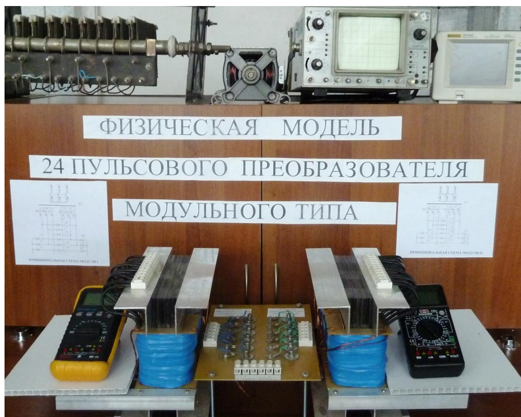
Рисунок 3.20 – Элементы физической модели 24-х пульсового модульного ТВА с кольцевыми вентильными схемами
