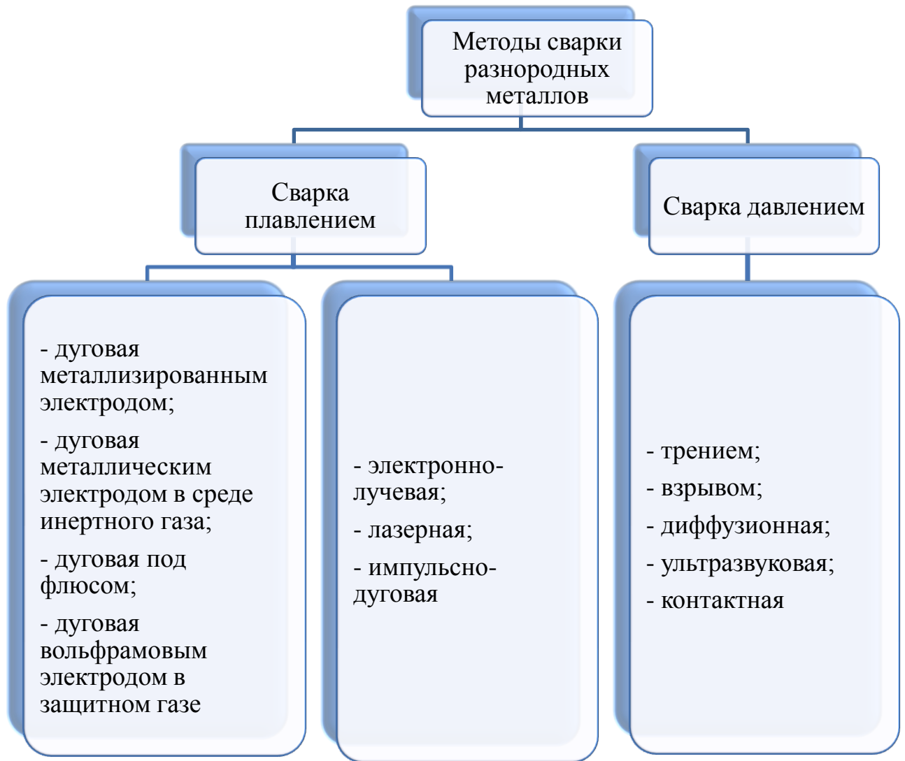
Рисунок 1.1 – Методы сварки, наиболее часто используемые для соединения разнородных металлов [91]
