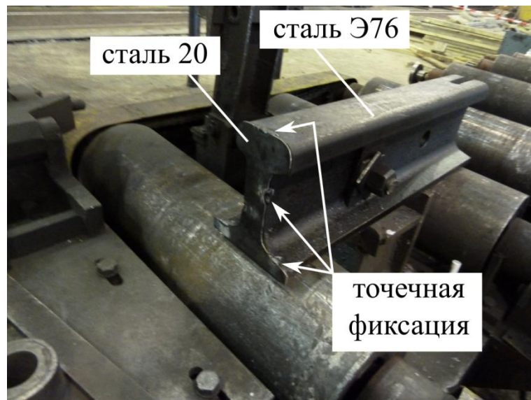
Рисунок 6.18 – Барьерные пластины из низкоуглеродистой стали толщиной 20 (а) и 5 (б) мм, закрепленные на рельсовых заготовках
