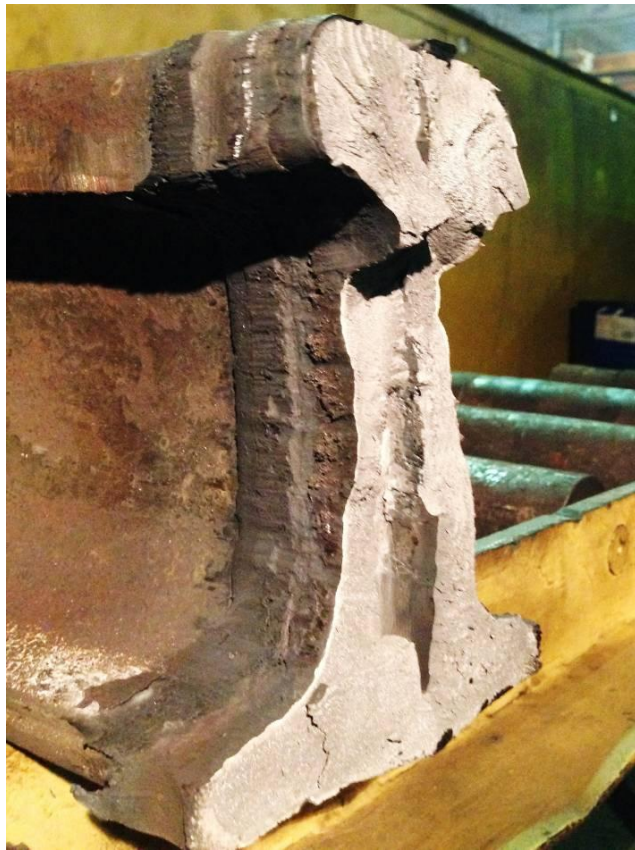
Рисунок 6.25 – Характерные изломы сварных соединений, полученных с использованием барьерных пластин из низкоуглеродистой стали толщиной 20 мм (а) и 5 мм (б) после испытаний на трехточечный изгиб
