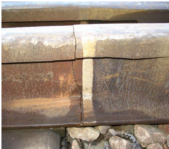
Рисунок 6.1 – Выбоины на разъемных болтовых соединениях крестовин с рельсами (а) и дефекты в виде трещин в неразъемных конструкциях (б) крестовин
