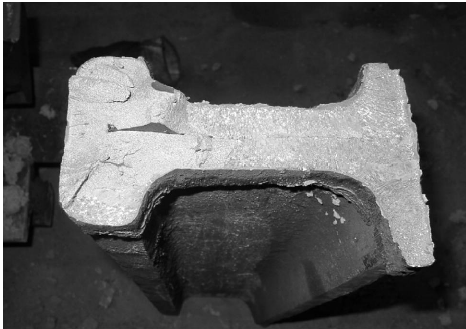
Рисунок 6.23 – Схема разрушения (а) и излом (б) сварного соединения со вставкой из хромоникелевой стали, полученного по стандартной заводской технологии, после испытания по схеме трехточечного изгиба
