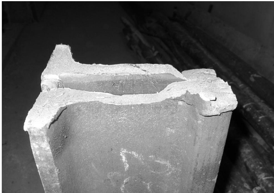
Рисунок 6.24 – Схема разрушения (а) и излом (б) сварного соединения, полученного с использованием дополнительной вставки из стали 20 после испытаний по схеме трехточечного изгиба.
