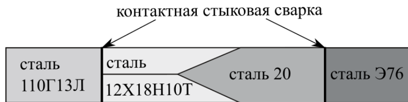
Рисунок 6.29 – Использование промежуточной вставки, полученной методом сварки взрывом заготовок из сталей 20 и 12Х18Н10Т: а – схема получения комбинированной вставки сваркой взрывом, б – использование комбинированной вставки для сварки разнородных сталей
