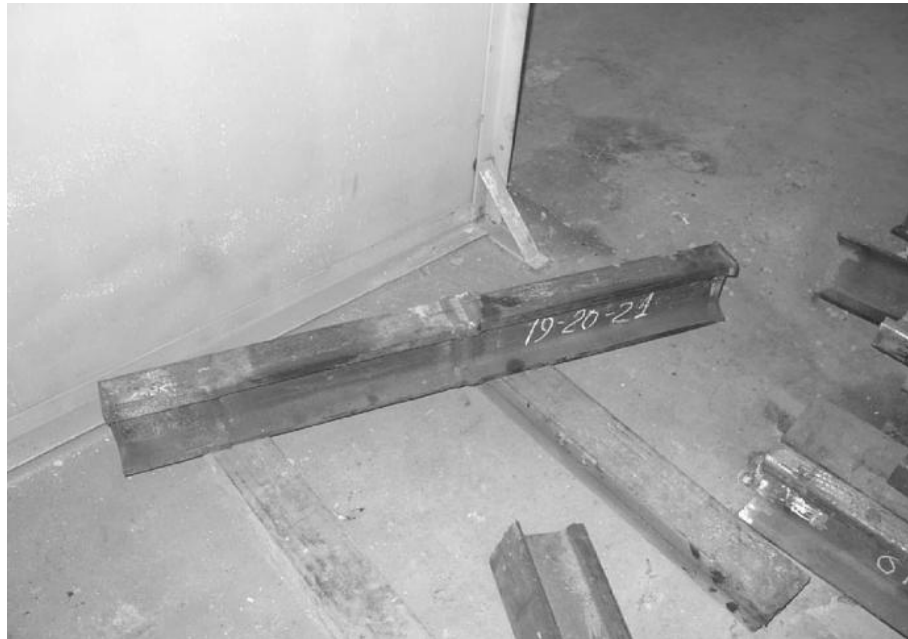
Рисунок 6.17 – Прототип комбинированной крестовины, сформированный с использованием дополнительной низкоуглеродистой вставки
