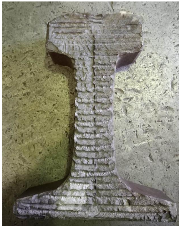
Рисунок 6.26 – Изломы сварных соединений с наплавленной легированной вставкой при частичном (указано стрелками) (а) и полном (б) разрушении по границе сопряжения заготовок из углеродистой и хромоникелевой сталей
