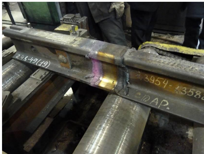
Рисунок 6.20 – Комбинированные конструкции крестовин, полученные с использованием барьерных пластин толщиной 20 (а) и 5 мм (б)
