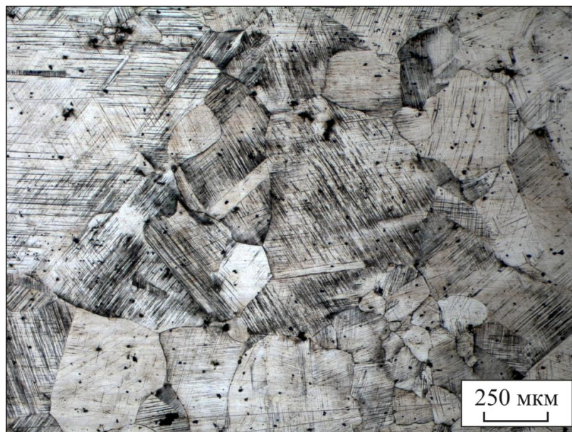
Рисунок 4.5 – Частично рекристаллизованная структура стали Гадфильда в сваренной взрывом композиции «сталь 20 – сталь 110Г13Л»
