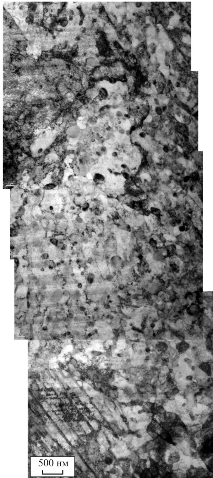
Рисунок 5.12 – Смешанный по форме перлит в зоне термического влияния стали Э76 (область 3, рисунок 5.9) после импульсной электродуговой наплавки проволоки А7-IG (просвечивающая электронная микроскопия)
