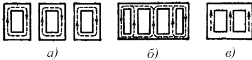
Рисунок 2.3 – Пути замыкания третьих гармоник магнитного потока в 3-фазных трансформаторах: а) в группе однофазных трансформаторах; б) в трехфазном трансформаторе броневого типа; в) в трехстержневом трансформаторе
