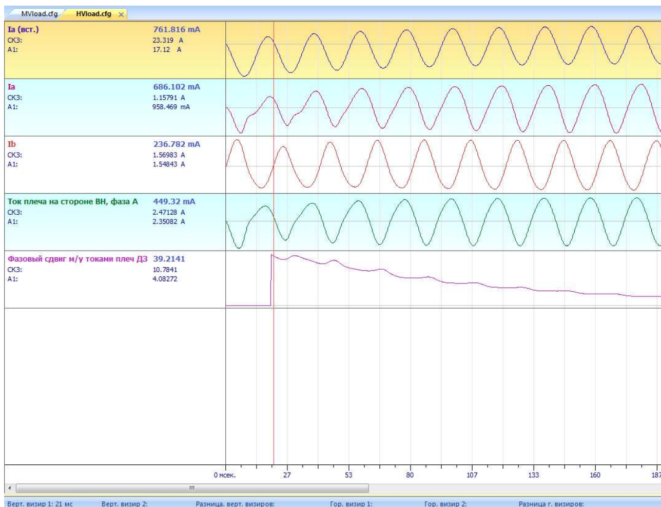
Рисунок Г.8 – Определение фазового сдвига между токами плеч ДЗ при внешнем 3-фазном КЗ, сопровождающимся насыщением ТТ, с помощью цифровых фильтров Фурье
