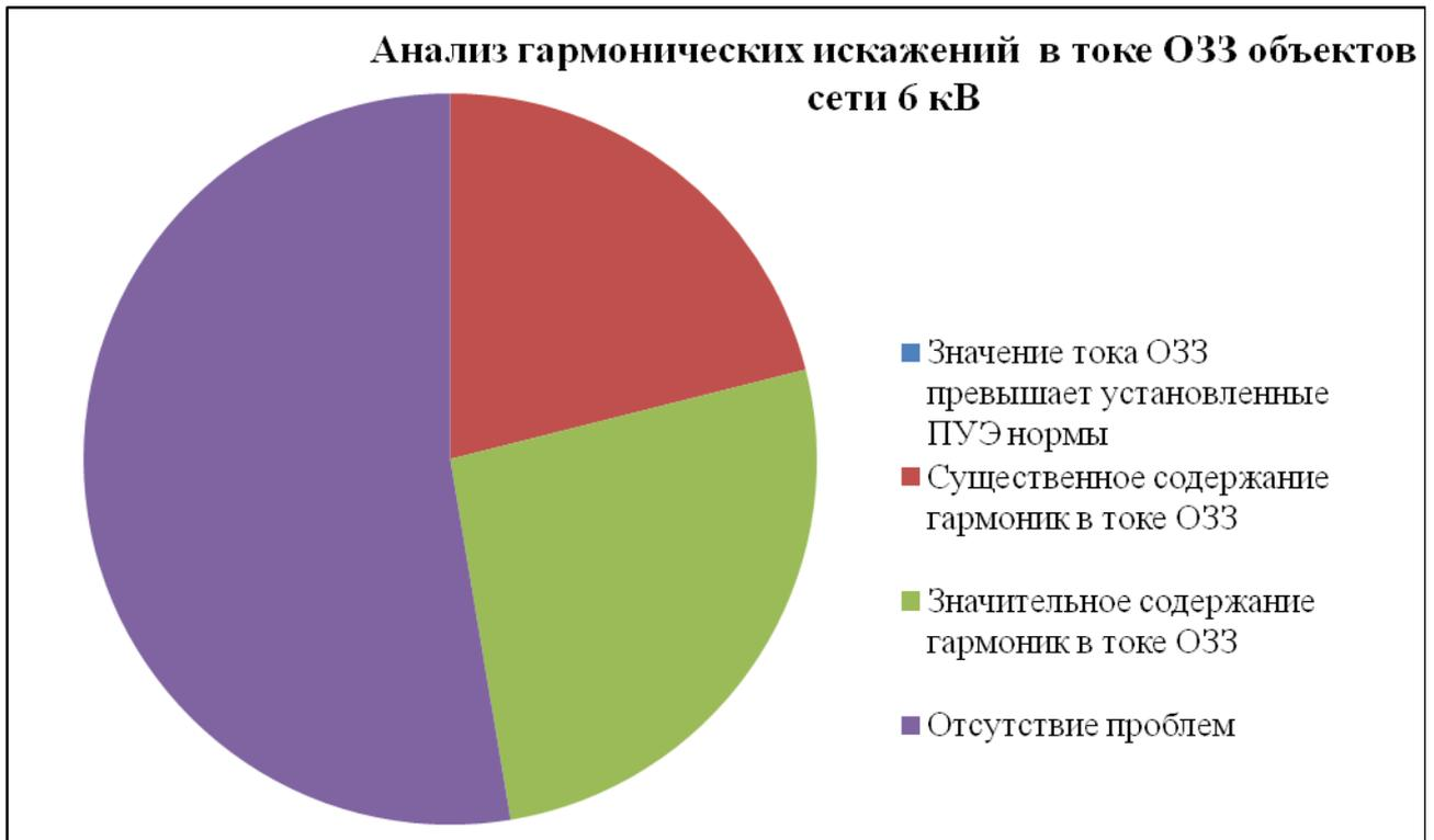
Рисунок 2.4 - Анализ содержания гармонических искажений в токе ОЗЗ всех исследованных объектов сети 6 кВ
