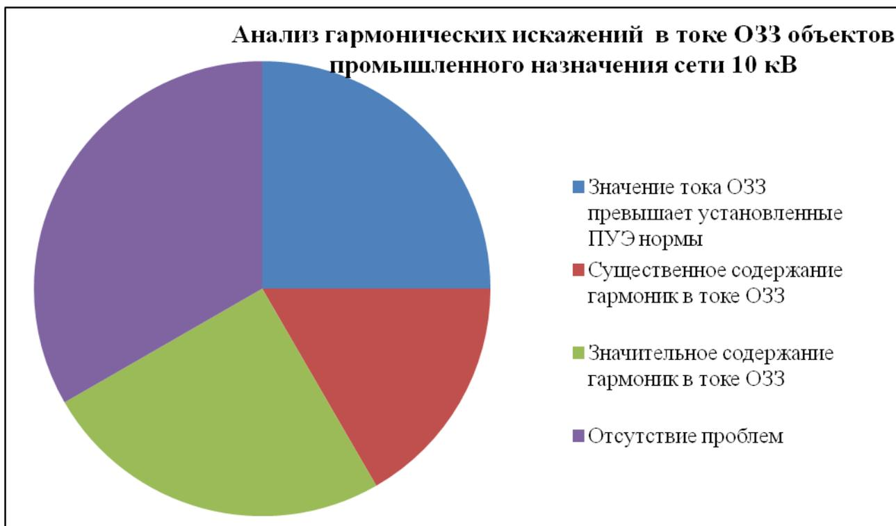
Рисунок 2.8 - Анализ содержания гармонических искажений в токе ОЗЗ объектов промышленного назначения сети 10 кВ
