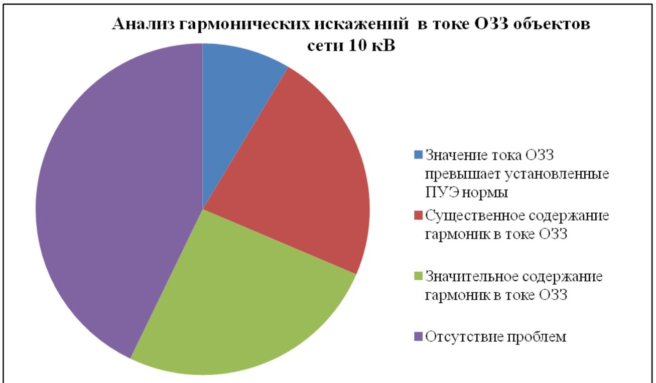
Рисунок 2.5 - Анализ содержания гармонических искажений в токе ОЗЗ всех исследованных объектов сети 10 кВ
