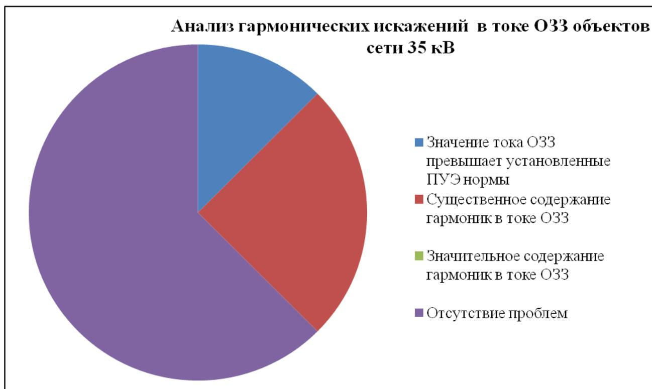
Рисунок 2.6 - Анализ содержания гармонических искажений в токе ОЗЗ всех исследованных объектов сети 35 кВ
