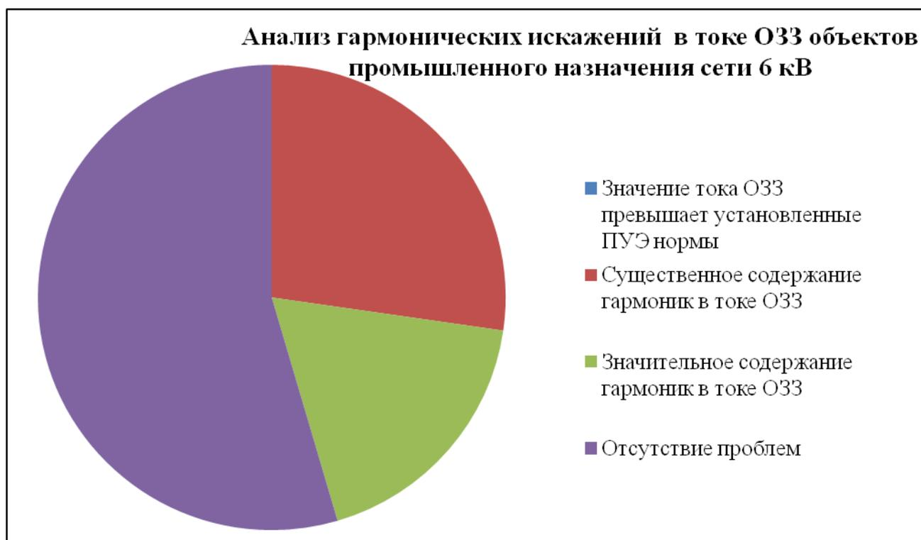
Рисунок 2.7 - Анализ содержания гармонических искажений в токе ОЗЗ объектов промышленного назначения сети 6 кВ
