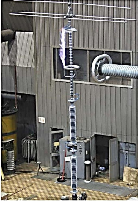
а) испытания напряжением промышленной частоты. Общий вид объекта испытаний
