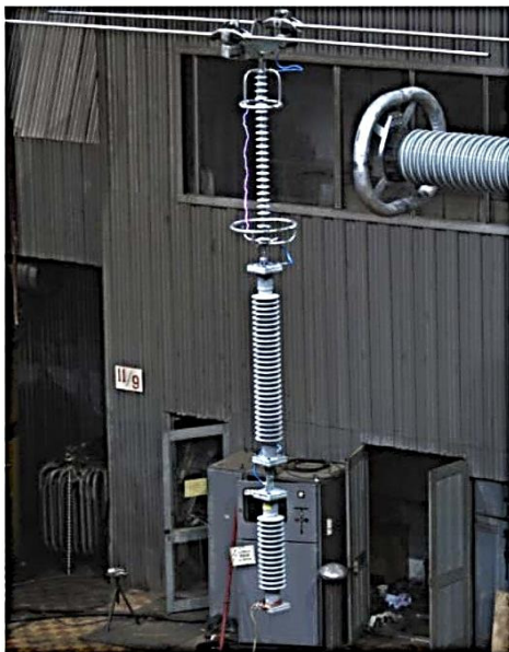
в) испытания напряжением коммутационного импульса. Общий вид объекта испытаний
