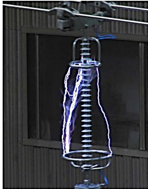
б) испытания напряжением промышленной частоты. Вид воздушного промежутка
