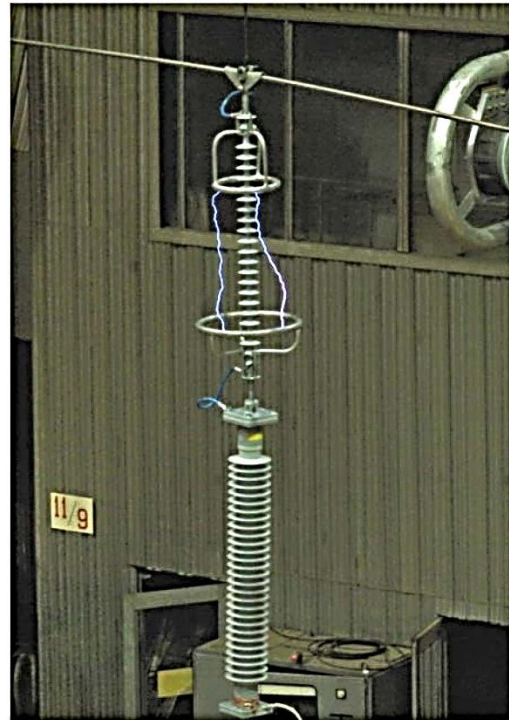
б) испытания напряжением коммутационного импульса. Общий вид объекта испытаний
