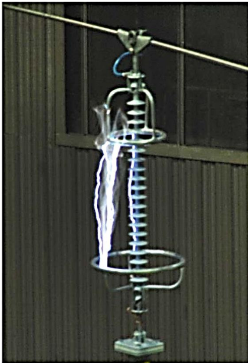
а) испытания напряжением промышленной частоты. Вид воздушного промежутка
