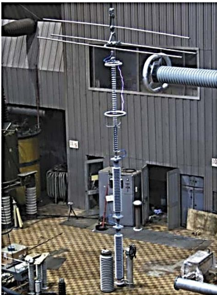
в) испытания напряжением коммутационного импульса. Общий вид объекта испытаний
