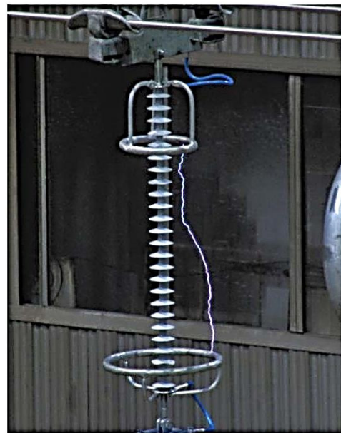
г) испытания напряжением коммутационного импульса. Вид воздушного промежутка
