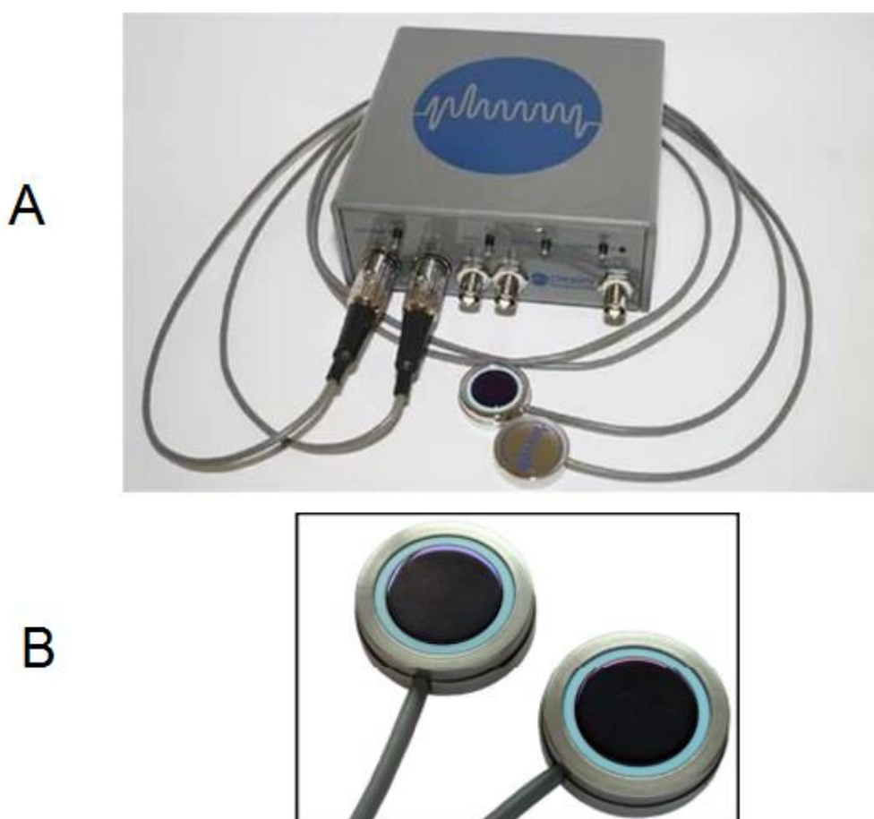
Рисунок 5 –А–общий вид устройства регистрации ЭКС, В –внешний вид датчиков PS 25101В фирмы Plessey Semiconductors
