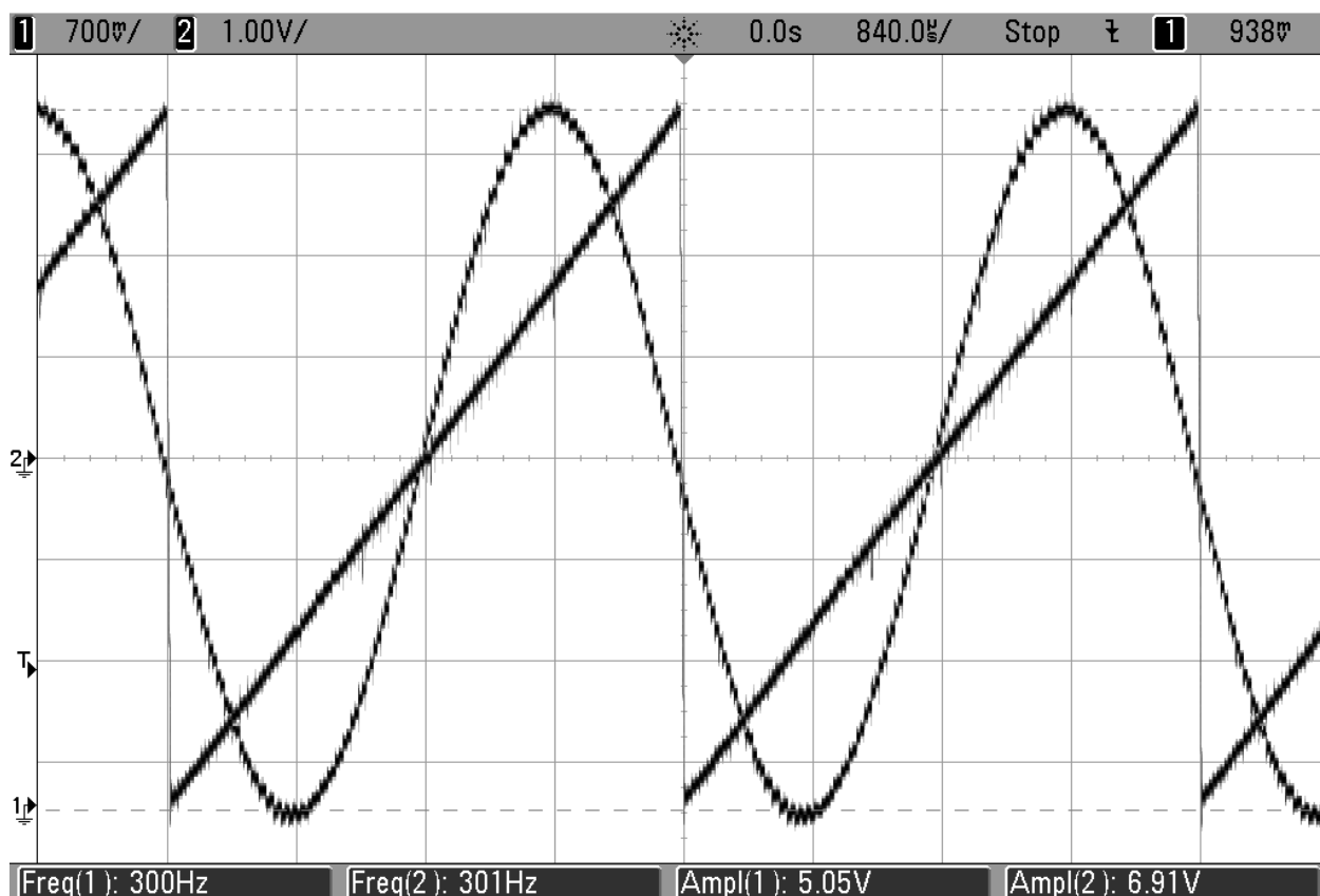
Рисунок 2.7 – Входной сигнал (синус) и выходной сигнал угла CORDIC, частота 6000 об/мин
