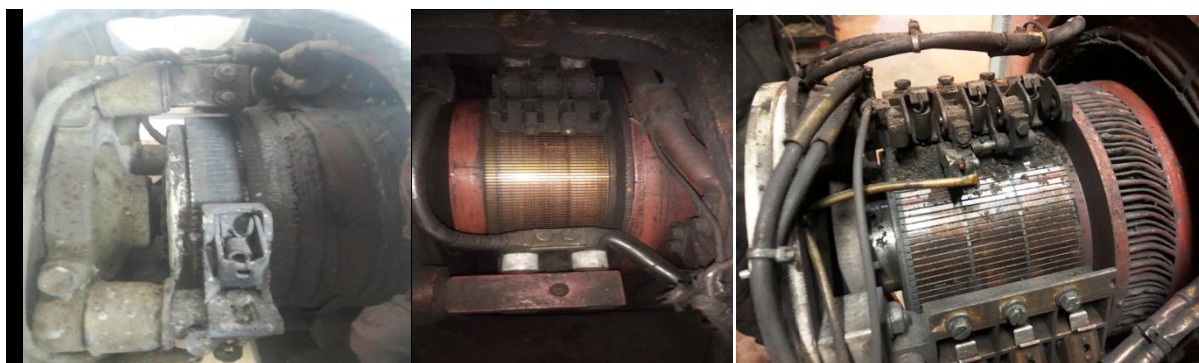
Рисунок 2.2 - Переброс электрической дуги по коллектору ТЭД
