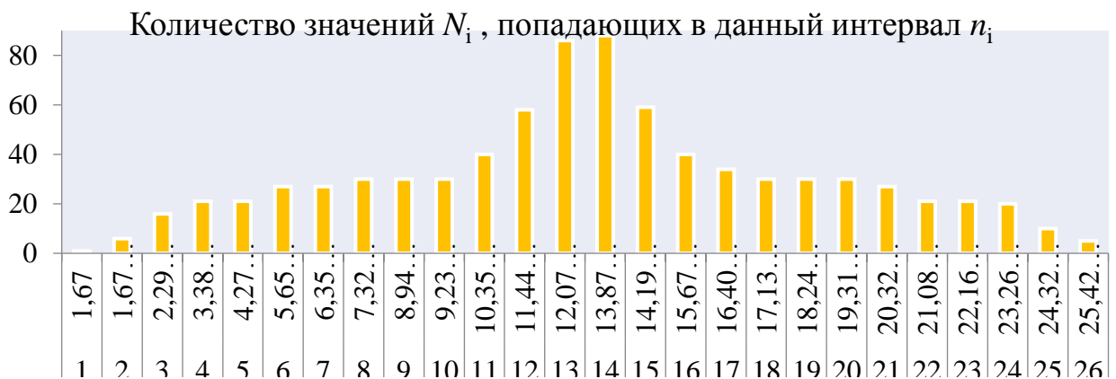
Рисунок 3.6 – Распределение контролируемых параметров по высоте остаточного ресурса щёток
