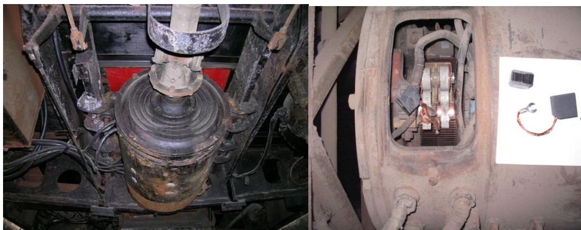
Рисунок 1.5 – Электродвигатель постоянного тока на ЭПС и ЩКУ с составными щетками
