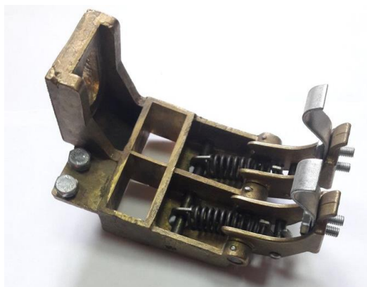
Рисунок 1.2 – Конструкция стандартного щеткодержателя ЭДПТ
