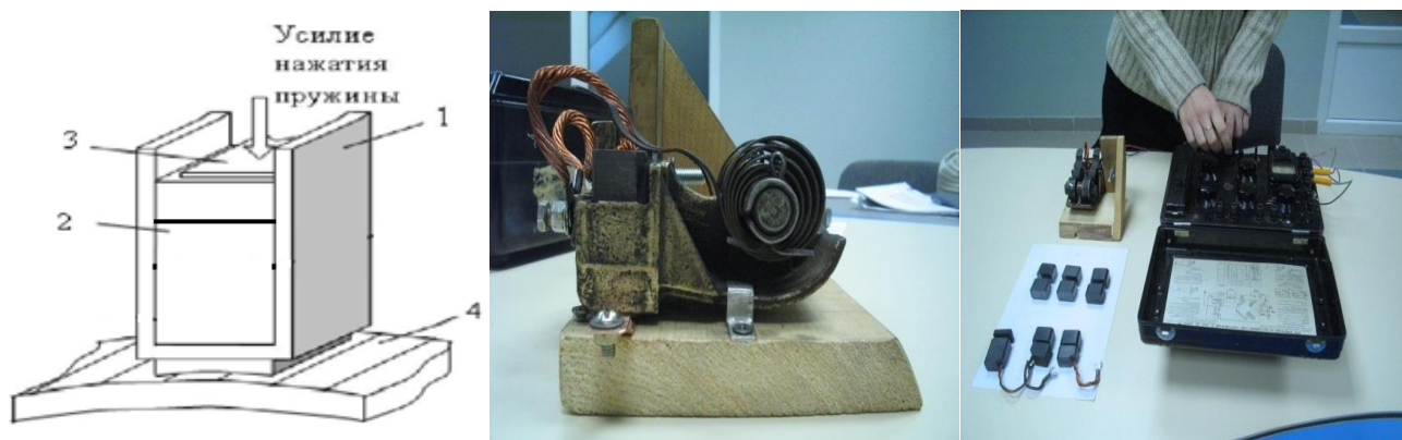
Рисунок 4.12 - Модель измерения нажимного усилия на щетку: 1 – щеткодержатель, 2 – составная щетка, 3 – нажимная пластина с рельефной поверхностью, 4 – коллектор; регулирование усилия нажатия пружины на испытуемые щетки (усилие нажатия 2 кгс)
