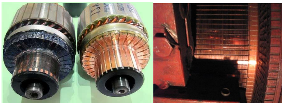
Рисунок 2.4 – Состояние политуры и неисправности коллектора
