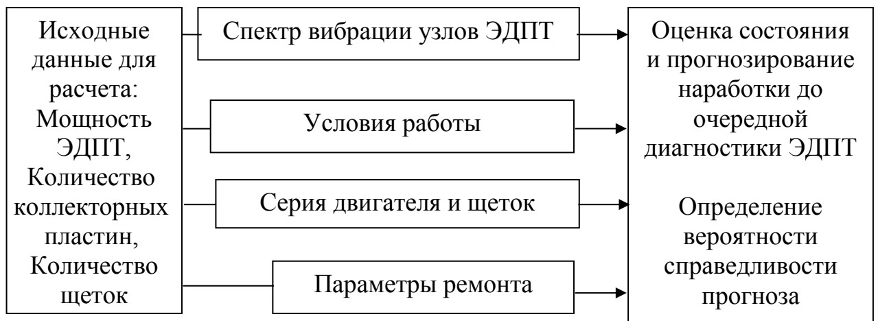
Рисунок 5.1 – Блок-схема прогнозирования срока службы электродвигателя
