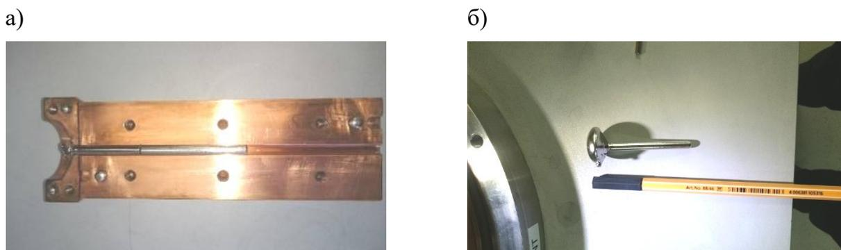
Рисунок 2.4 – Получение прутков из сплавов *Ti-Nb*: (а) отливка внутри литейной формы, (б) отливка, извлеченная из формы
