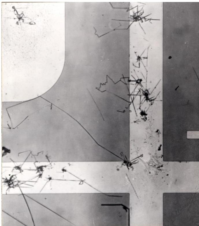
Рисунок 2.11 – Дендритные осадения металлоидного мышьяка
