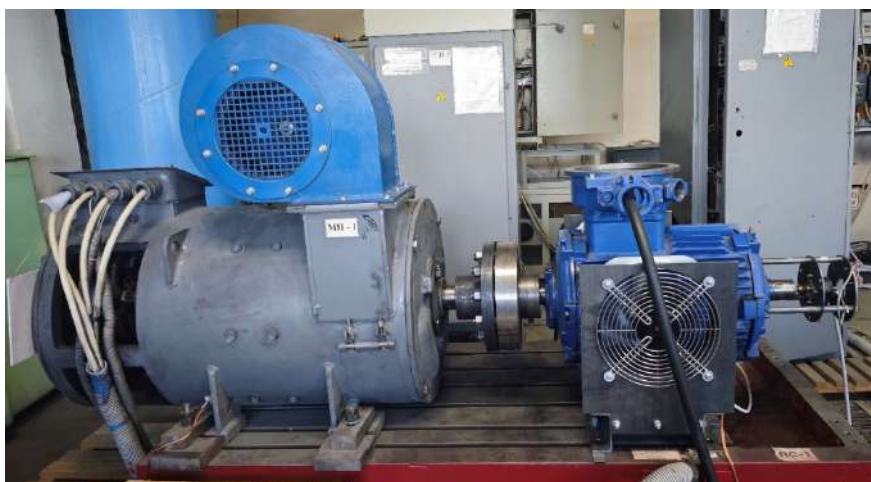
Рисунок 4.5 – Нагрузочный каскад из смуфтованных 4ПФМ280S и АИМУР180М4У1
