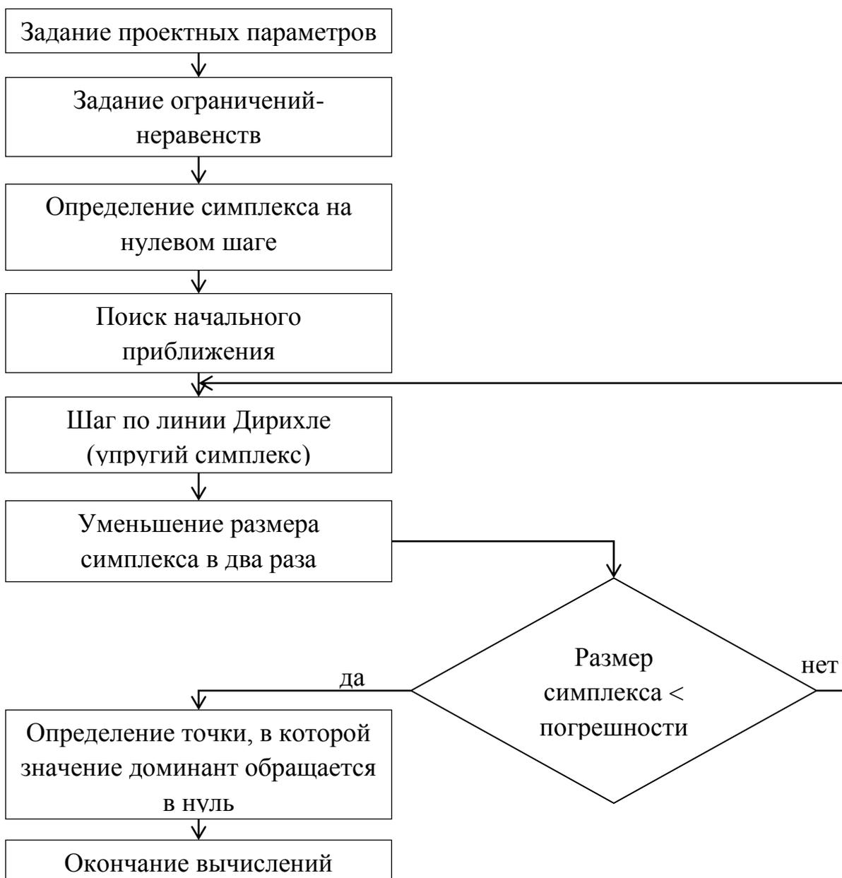
Рисунок 3.4 – Общая схема алгоритма оптимизации
