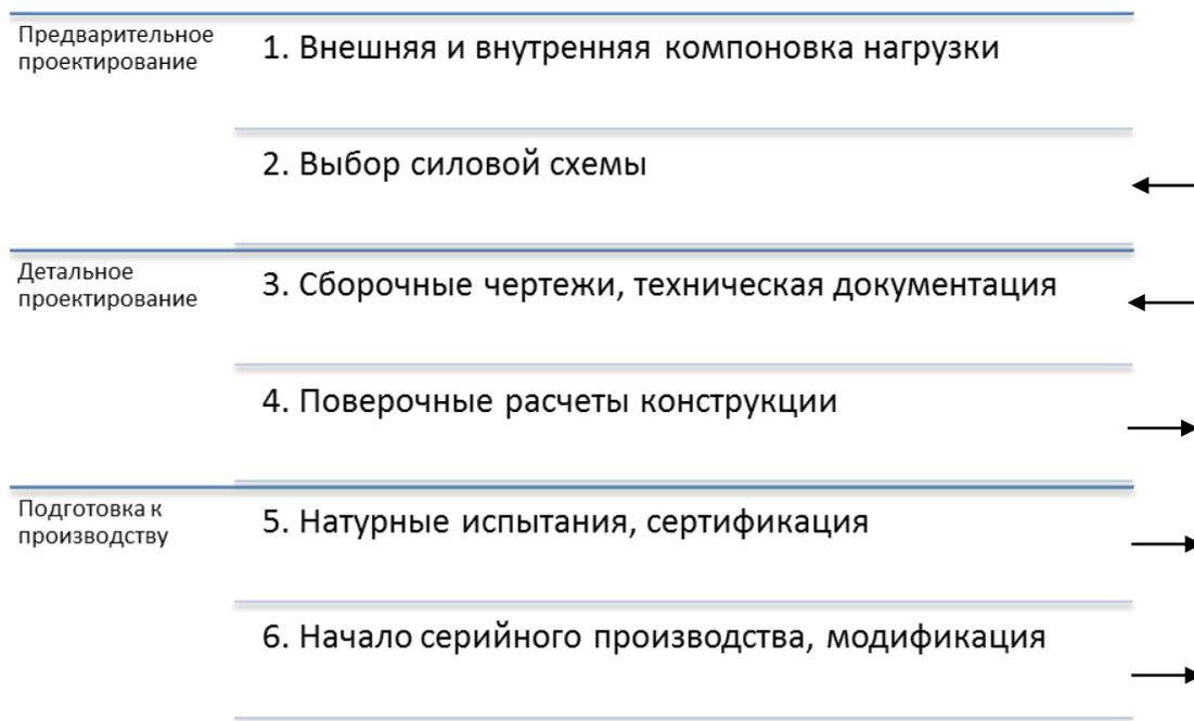
Рисунок 1.1 – Традиционная схема проектирования силовых конструкций
