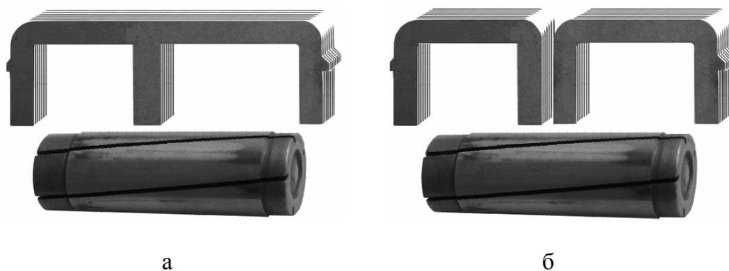
Рисунок 6.37 – Конструктивное исполнение магнитопровода статора ЛЭМД:
