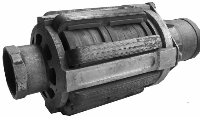
Рисунок 6.36 – Внешний вид ударного узла СЭМУД ИЭ-4207
