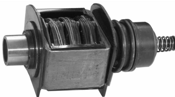
Рисунок 5.34 – Электромагнитный ударный узел перфоратора ТТ-312Б предприятия ООО «ЭИТТ» г. Новосибирск
