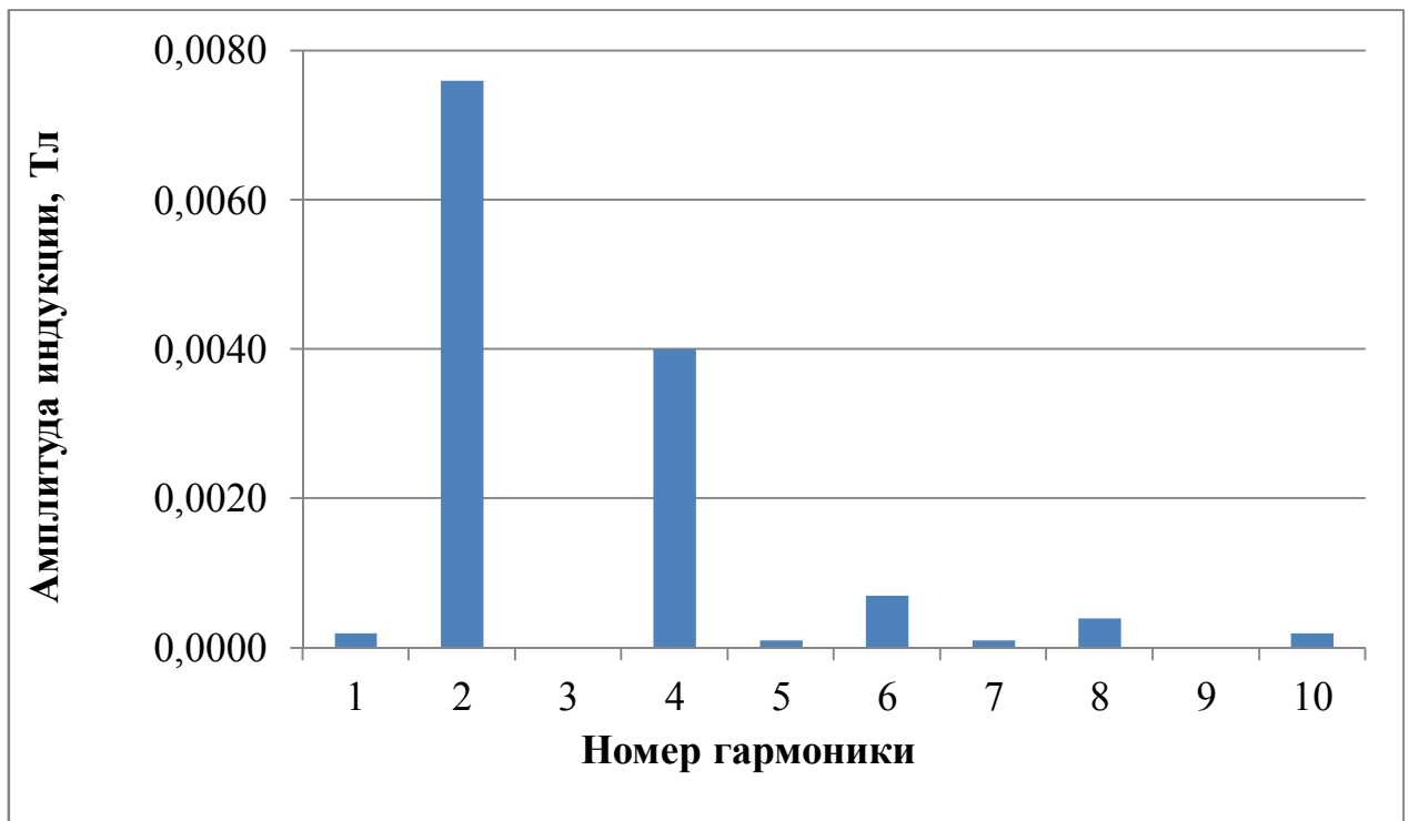
Рисунок 3.17 - Гармонический анализ индукции магнита при работе генератора аварийного торможения в режиме холостого хода
