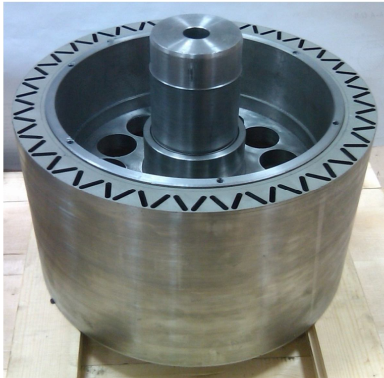
Рисунок 1.8 – Ротор коллекторного типа с V образными пазами
