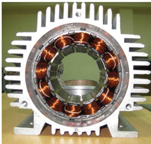
Рисунок 1.10 – Статор 10-и полюсной машины с дробной зубцовой обмоткой
