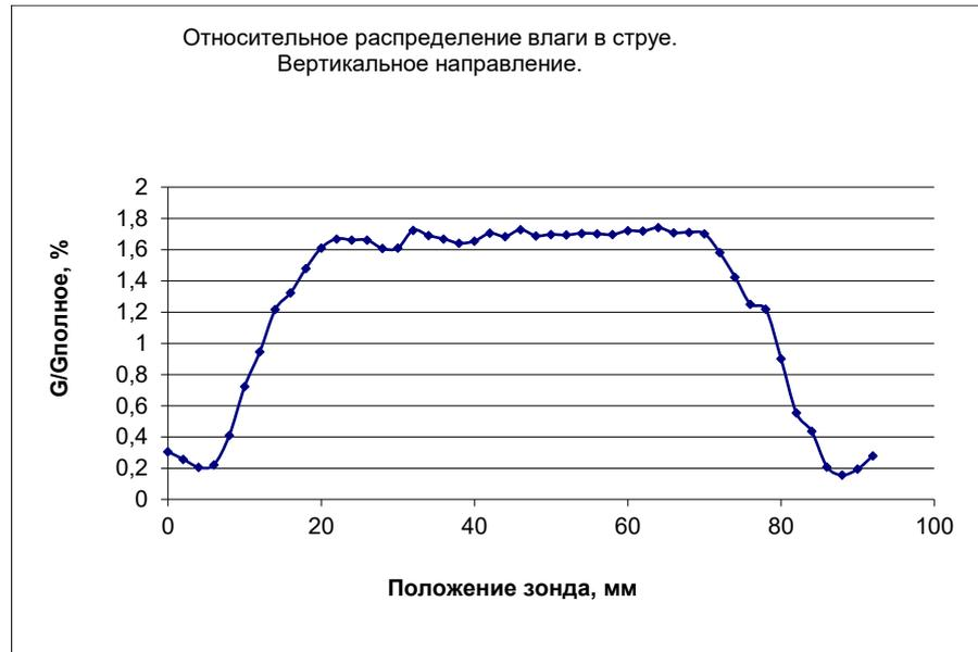
Рисунок 2.17 – Относительное распределение влаги в потоке.  $G$  – локальный расход воды,  $G_{\text{полное}}$  – суммарный расход воды
