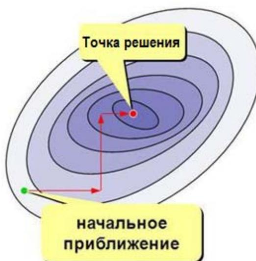
Рисунок 3.1 - Метод покоординатного спуска к решению
