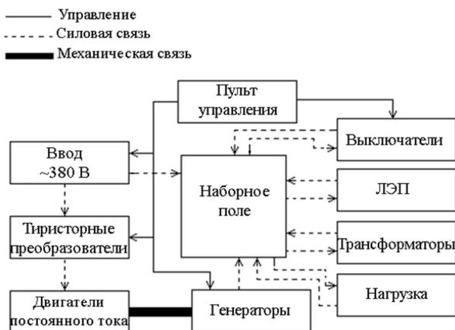
Рисунок 4.9 - Структурная схема ЭДМ
