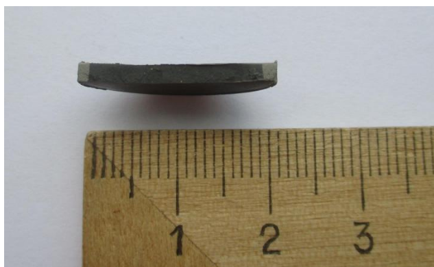
Рисунок 2.6 – Общий вид компакта, спеченного из частично окисленного порошка никеля в контакте с дисками медной фольги по торцам и в контакте с графитовой фольгой по боковой поверхности. Температура спекания 800 °С
