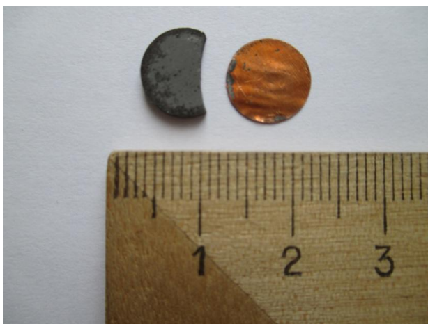
Рисунок 2.25 – Общий вид компакта, спеченного из порошка железа в контакте с медной фольгой при температуре 600 °С. Периферия компакта выглядит более темной
