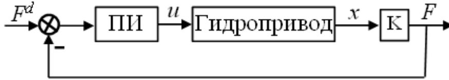
Рисунок 5.2—Контур формирования желаемой силы
