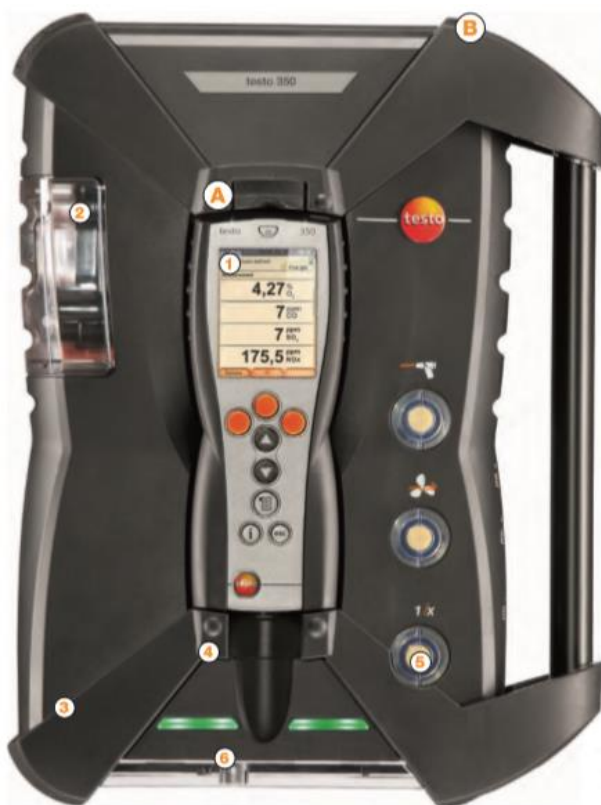
Рисунок 4.7 – Газоанализатор TESTO 350: А – управляющий модуль; В – блок анализатора; 1 – графический дисплей; 2 – система автоматического мониторинга конденсатосборника; 3 – корпус; 4 – индикатор статуса; 5 – пылевые фильтры; 6 – соединительные разъемы
