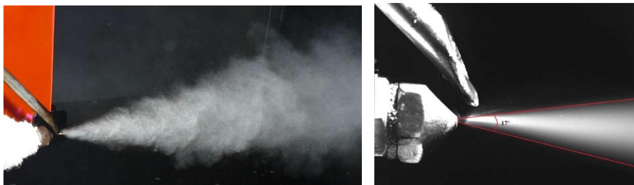
Рисунок 1.9 – Диспергирование жидкого топлива струей водяного пара
