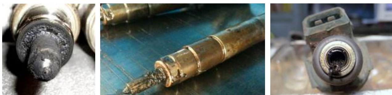
Рисунок 1.10 – Примеры закоксованных топливных форсунок
