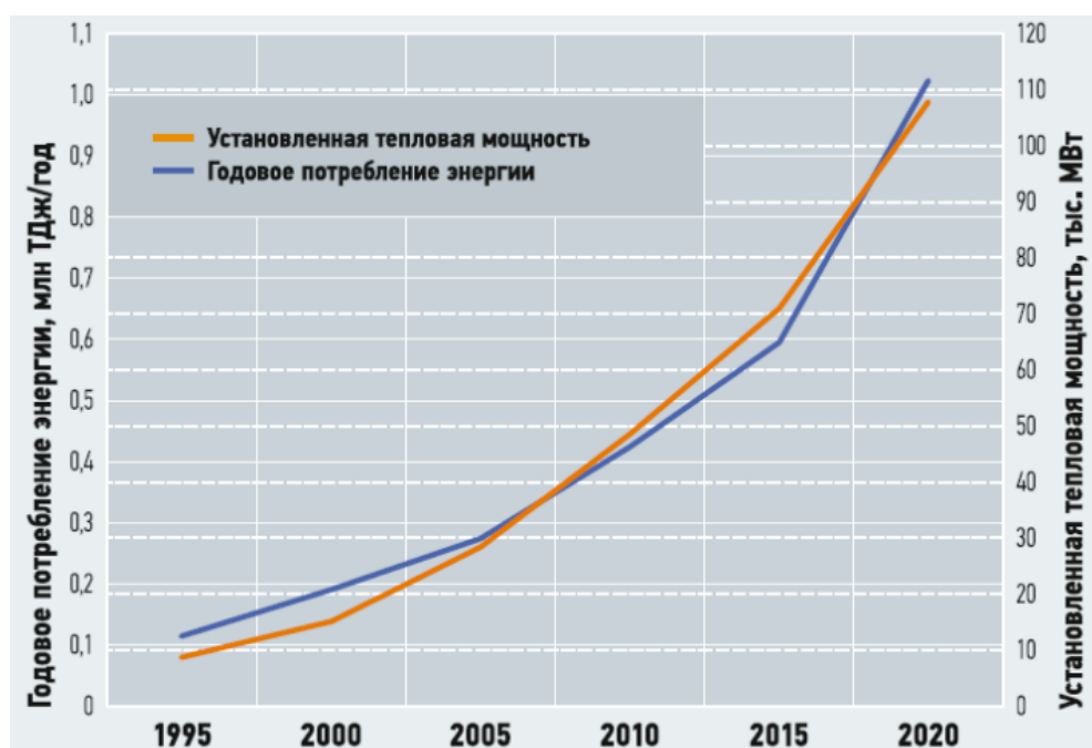
Рисунок 1.3 – Установленная мощность технологий прямого использования геотермальной энергии и потребление энергии в 1995–2020 годах
