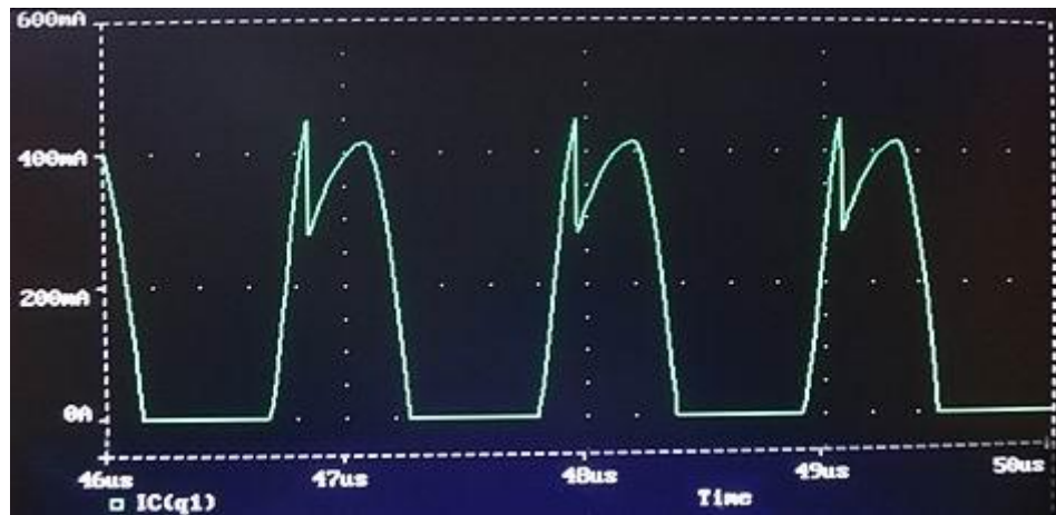
Рисунок 4.8 – Форма коллекторного тока усилителя на частоте 0,9 МГц
