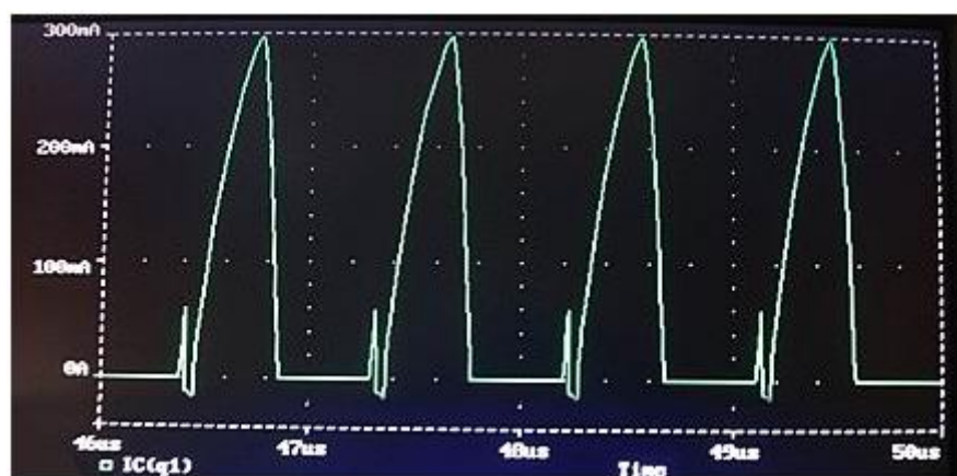
Рисунок 4.12 – Форма коллекторного тока усилителя на частоте 1,1 МГц
