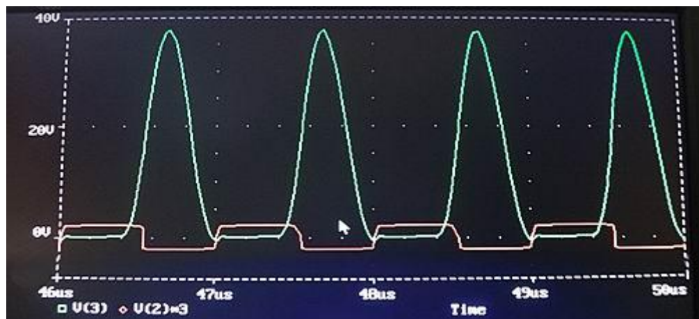
Рисунок 4.9 – Форма коллекторного напряжения усилителя на частоте 1 МГц
