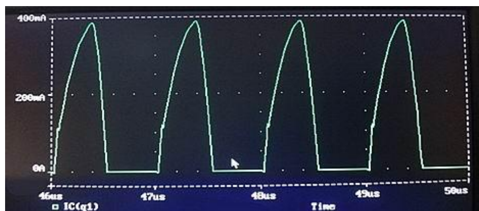
Рисунок 4.10 – Форма коллекторного тока усилителя на частоте 1 МГц
