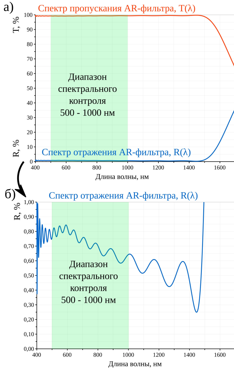
Рисунок 5 – Спектры отражения и пропускания просветляющего покрытия (Anti-Reflection фильтра) для работы в диапазоне 400 – 1500 нм перед окончанием нанесения последнего слоя: а) – в диапазоне 0 – 100 %, б) – в диапазоне 0 – 1 %
