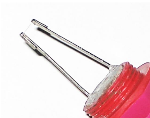
Рисунок 2.19 – Датчик термоанемометра для определения мгновенных значений средней по сечению скорости потока рабочего тела
