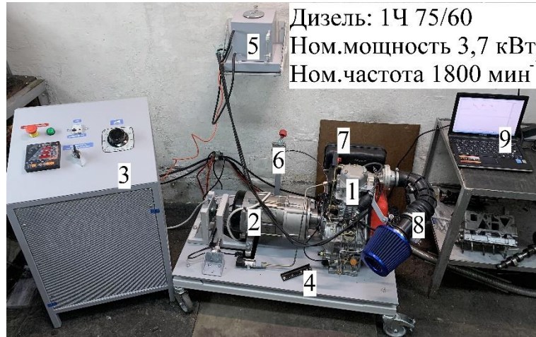
Рисунок 2.14 – Фото установки для стендовых испытаний ДВС: 1 – одноцилиндровый дизель; 2 – электрическое нагружающее устройство (генератор); 3 – блок управления установкой (пуск / останов / нагрузка / приборы и т.д.); 4 – основание (виброгасящая плита); 5 – бак для хранения топлива; 6 – рукоятка управления подачей топлива; 7 – система выхлопа; 8 – система впуска; 9 – ноутбук для сбора и обработки данных испытаний
