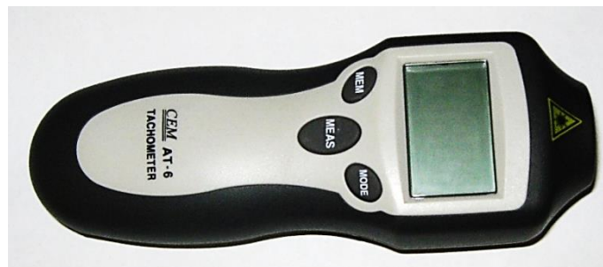
Рисунок 2.32 – Бесконтактный тахометр (фирма СЕМ, модель АТ-6) для определения значений скорости вращения вала ТК
