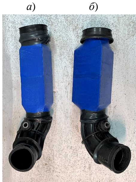
Рисунок 4.40 – Фотографии впускного коллектора с квадратным (а) и треугольным (б) каналами для дизеля 1Ч 7,5/6,0
