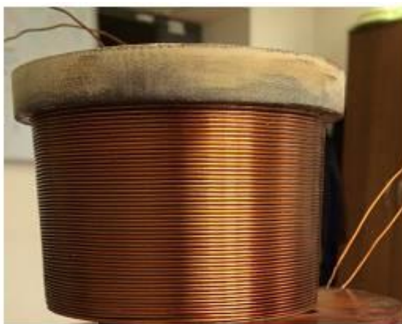
Рисунок 4.20 — Катушка якоря электродинамического привода
