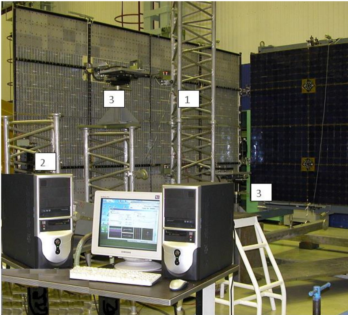
Рисунок 4.5 — Модальные испытания солнечной батареи
