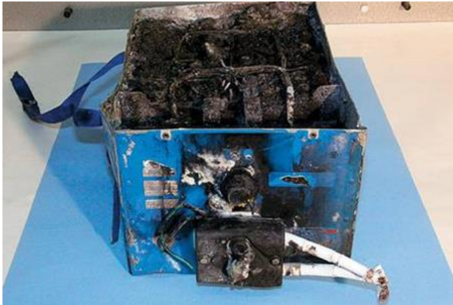
Рисунок 1.2 – Последствия теплового разгона аккумуляторной батареи LVP65 [50]
