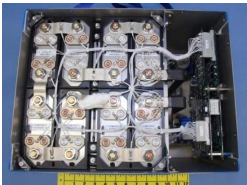
Рисунок 1.1 – Конструкция аккумуляторной батареи самолета Boeing 787 [50]
