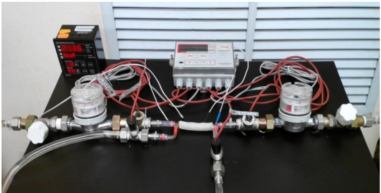
Рисунок 3.31 – Общий вид установки для определения коэффициента теплопроводности поликристаллических световодов с малым диаметром в рабочем режиме.
