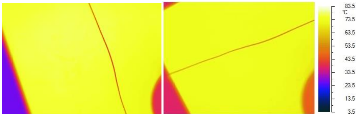
Рисунок 3.13 – Тепловизионное изображение проволоки, расположенной на источнике теплового излучения вертикально и горизонтально соответственно.
