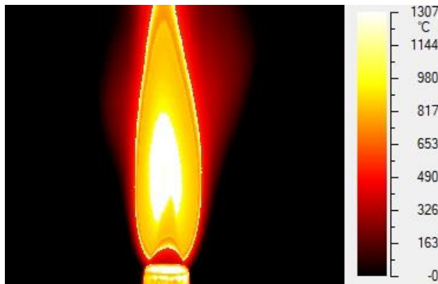
Рисунок 4.8 – Изображение переднего профиля пламени в ИК диапазоне спектра.
