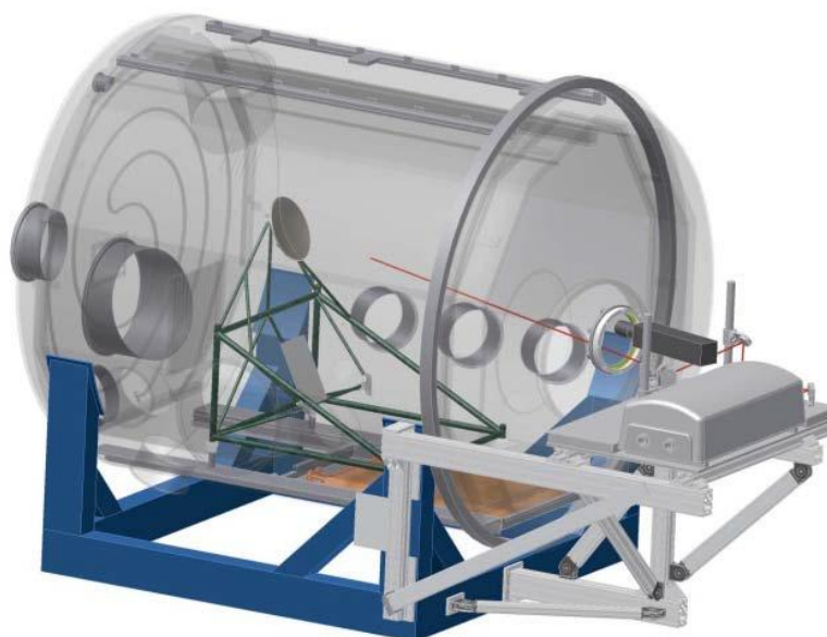
Рисунок 14 – Квалификационная установка ESPI на 2-метровой TVA IABG
