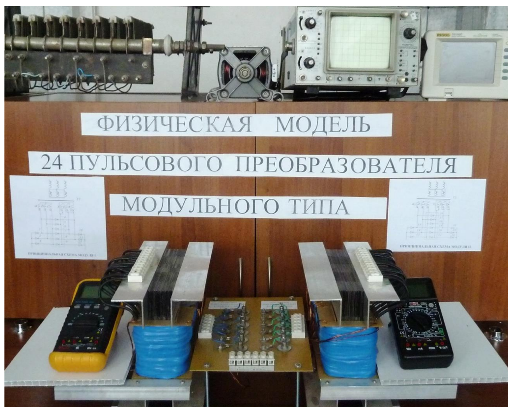
Рис.3.20 – Элементы физической модели 24-х пульсового модульного ТВА с кольцевыми вентильными схемами
