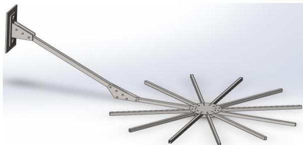
Рисунок 5 — Макет зонтичной антенны
