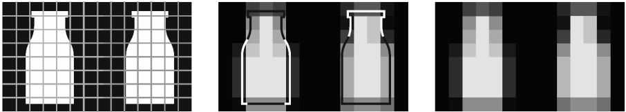
Рисунок 3 – Изменение формы изображения малоразмерного объекта в зависимости от его расположения на матрице фотоприемника
