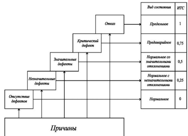
Рисунок 7 – Соотношение дефектов и состояний электрооборудования
