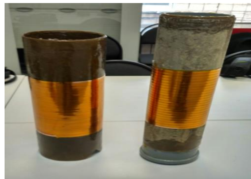
Рисунок 10 – Обмотки ВТСП трансформатора
